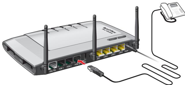
Anschluss eines ISDN-Telefons
