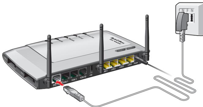
Anschluss mit DSL-Kabel
