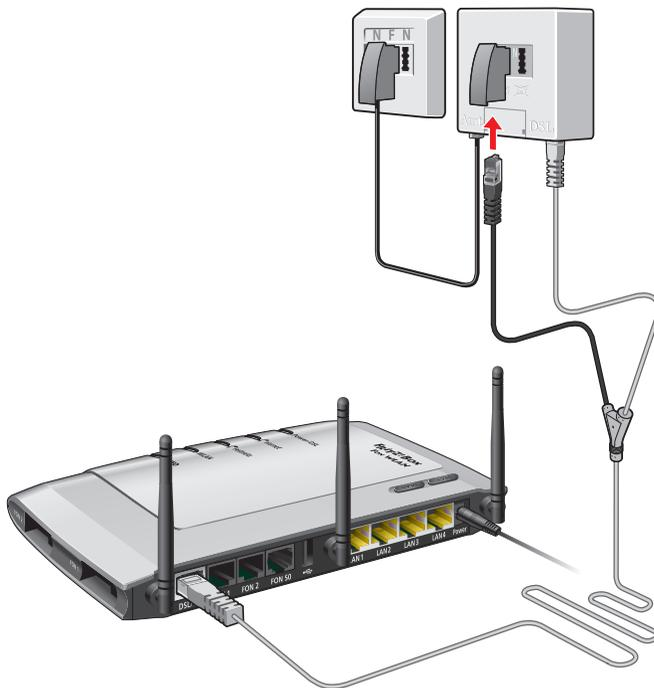
Anschluss am analogen Telefonanschluss über den DSL-Splitter
