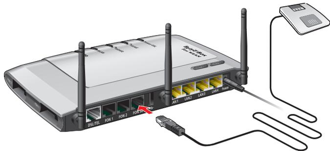
Anschluss einer ISDN-Telefonanlage
