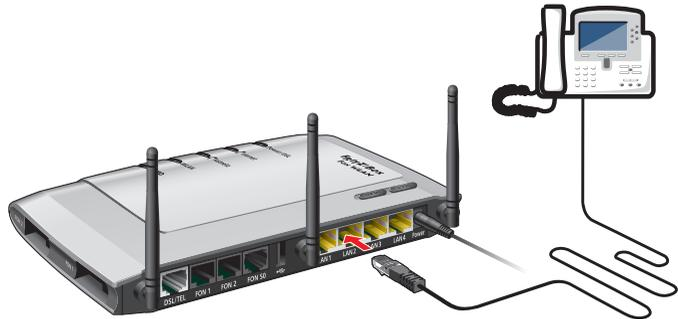
IP-Telefon an Netzwerkanschluss der FRITZ!Box anschließen
