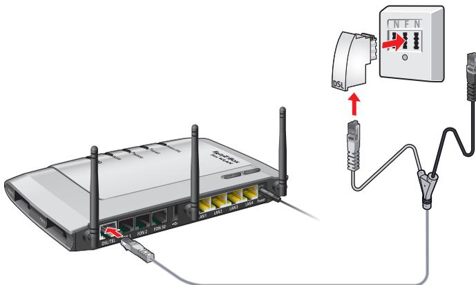
Anschluss mit DSL-/Telefonkabel und DSL-Adapter
