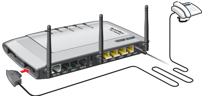
Anschluss eines analogen Telefons mit TAE-Stecker
