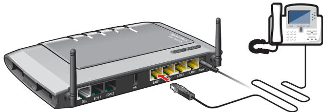
IP-Telefon an Netzwerkanschluss der FRITZ!Box anschließen
