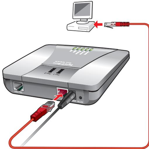
Anschluss eines Computers an einen Netzwerkanschluss der FRITZ!Box
